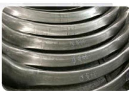
九龙汽车扭力梁液压成形管件实物零件
