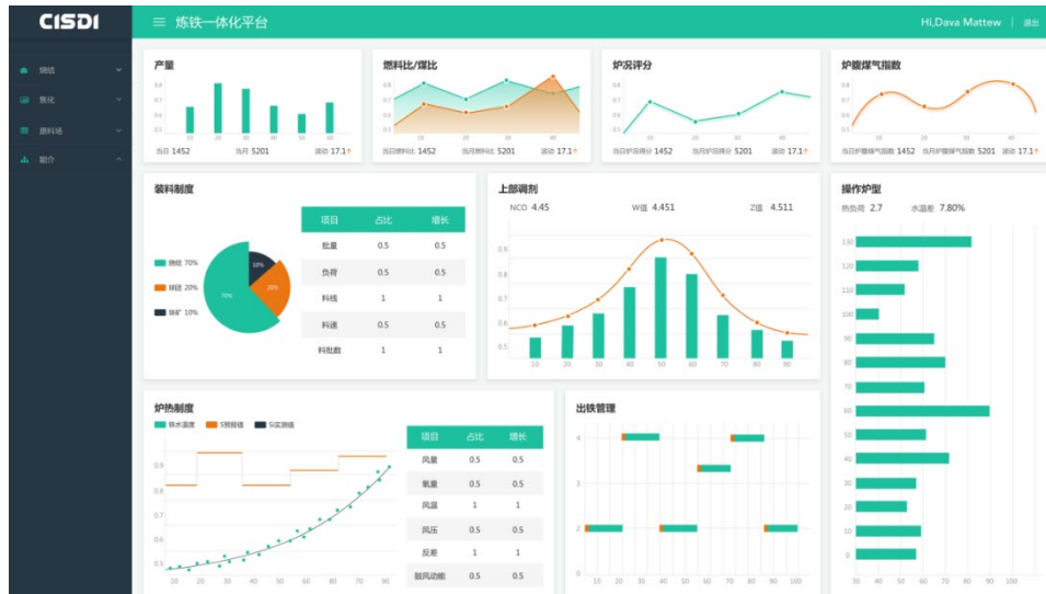
铁区一体化智能管控平台高炉系统界面
