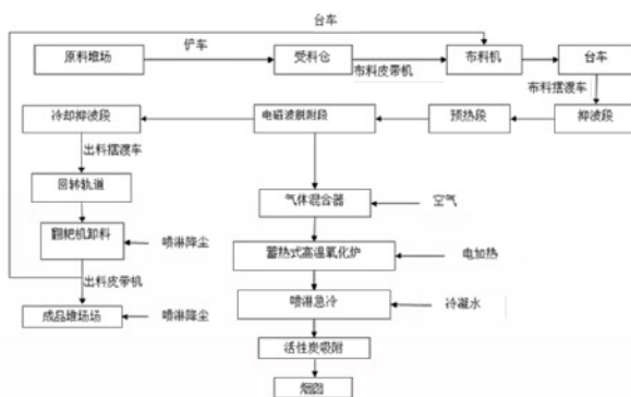
图 3 微波修复有机污染土工艺流程
